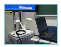
電源コード・LANケーブル・TVに接続されているRGBケーブルをつなぎ、PCを起動する
