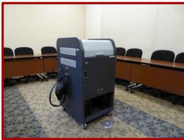
①ワゴンを、カーブが垂直な面をスクリーン側にして設置する。
