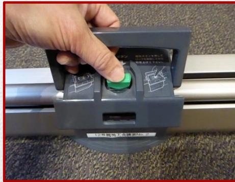
②解除ボタンを押してロックを解除し、上に引き上げる。
